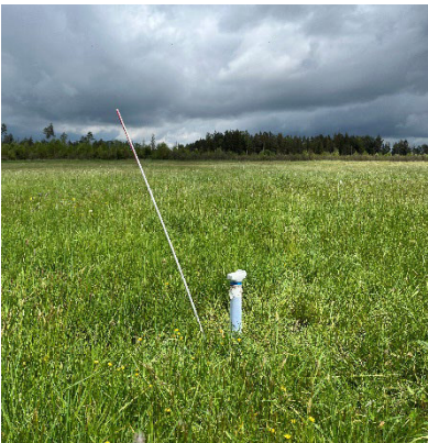
Abb. 2 Moorwasserstandspegel mit einem Automatiklogger auf der zukünftigen PV-Fläche bei Mooseurach
