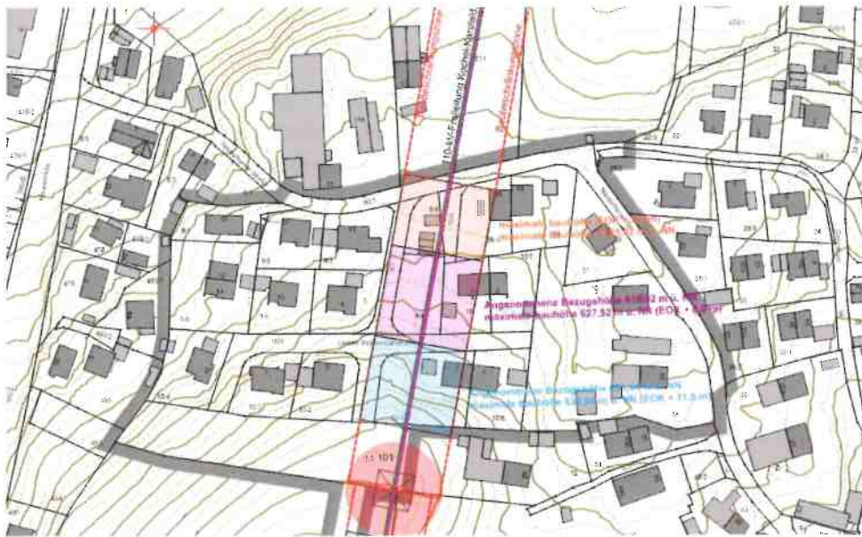
Abb. 6: Plangebiet mit Leitungsverlauf der 110 kV Freileitung der Bayernwerk Netz GmbH, ohne Maßstab, Quelle: Bayerische Vermessungsverwaltung, Stand 04/2020, eigene Darstellung, Angaben Bayernwerk Netz GmbH mit Stand 2018
