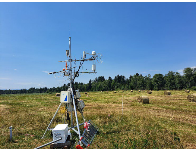
Abb. 3 Treibhausgasmessungen auf der zukünftigen PV-Fläche nahe dem Gut Mooseurach
